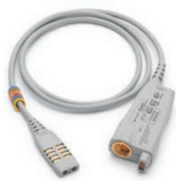
N2800A-03A InfiniiMax III probe amplifier
